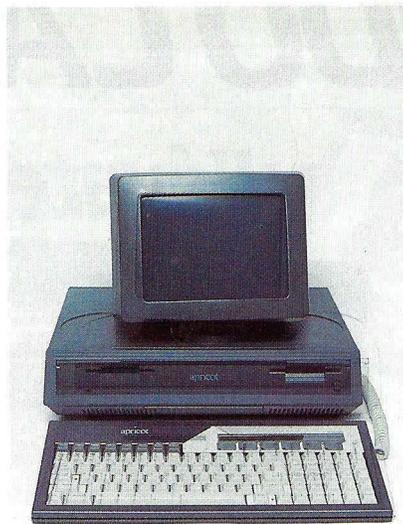
El teclado en sí se compone de 96 teclas y se podrían dividir en cinco partes: el teclado alfanumérico, las teclas de función (ocho), teclado numérico independiente, teclado de edición o teclas de movimiento del cursor y las seis teclas sensitivas que incluye bajo la micropantalla. Es más cómodo que el teclado anterior, al menos el formato de las teclas es más estándar y no da lugar a errores.
